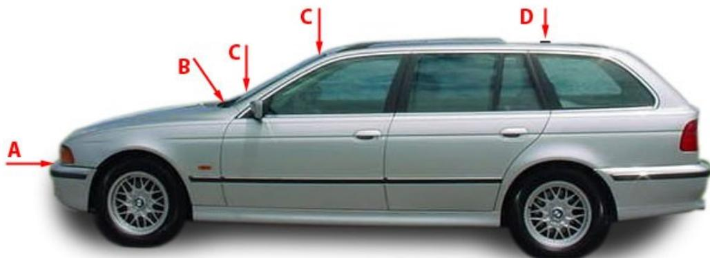
Bild 6: Mögliche Antennen-Montageorte am Beispiel eines Personewagens
